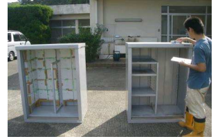
羊毛断熱材を設置した物置と、何も付けていない物置の比較
